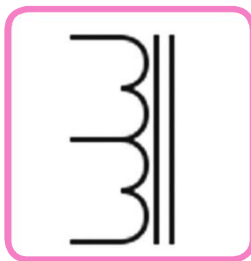
Sumber : Dokumen Kemdikbud Gambar 2.13. Simbol autotransformator
